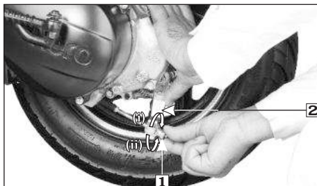
(1) Tuerca de ajuste (2) Brazo del freno (i) Disminuye juego libre (ii) Aumenta juego libre
