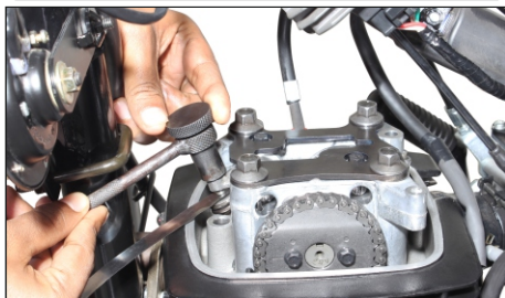
(5) Medidor (6) Tornillo de ajuste (7) Vástago de válvula (8) Tuerca de bloqueo
