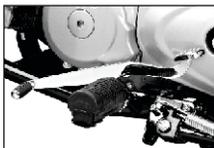
3. Encuentre la posición neutra y revise si el indicador (N) brilla en el grupo de Instrumentos con el encendido en "ON"
